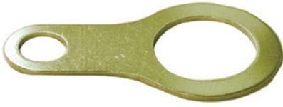
Кольца заземления рекомендуется использовать в тех случаях, когда экран кабеля крепится к кабельному вводу для получения того же потенциала, что и у других кабельных вводов корпуса.
