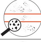
Пылезащищенное оборудование, проникновение пыли не предотвращается полностью, но пыль не может проникать в таком количестве, которое способно негативно повлиять на надлежащее функционирование оборудования или надежность. |
