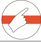
Защищено от проникновения посторонних твердых предметов диаметром 12,5 мм и более. Защищено от прикосновения пальцами к опасным частям..                                                                                     |
