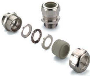
Латунный кабельный ввод для экранированного кабеля обеспечивает защиту от высокочастотных помех (затухание до 100 дБ). Контакт с экраном кабеля обеспечивается при помощи кольцевой пружины.
