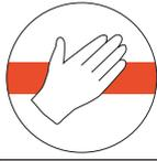
Защищено от проникновения посторонних твердых предметов диаметром 50 мм и более. Защищено от прикосновения ладонью к опасным частям.                                                                                          |
