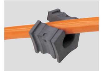
2. Вдавите уплотнительную ячейку с кабелем в открытый кабельный ввод. В KVT 63/4 плоская сторона уплотнительных ячеек должна быть направлена вверх!
